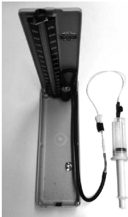
รูปที่ 1 เครื่องวัดความเจ็บปวดที่ประยุกต์จากเครื่องวัดความดันโลหิตที่ผู้วิจัยพัฒนาขึ้น
